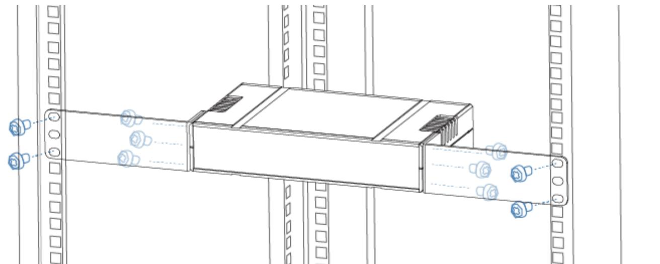
图2 单台设备安装示意图（使用长挂耳）
